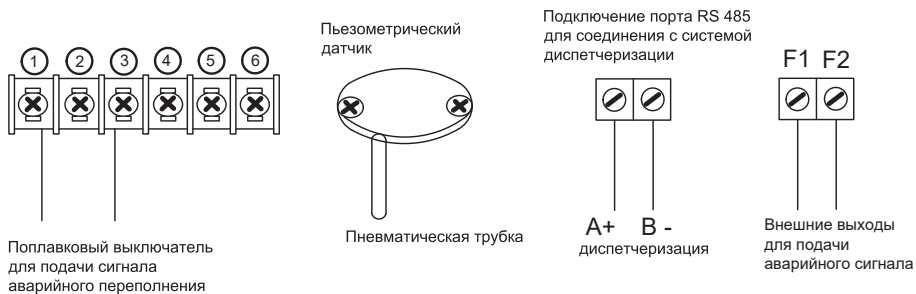
Рис. 14 Подключение реле уровня, порта диспетчеризации, внешней аварийной сигнализации
